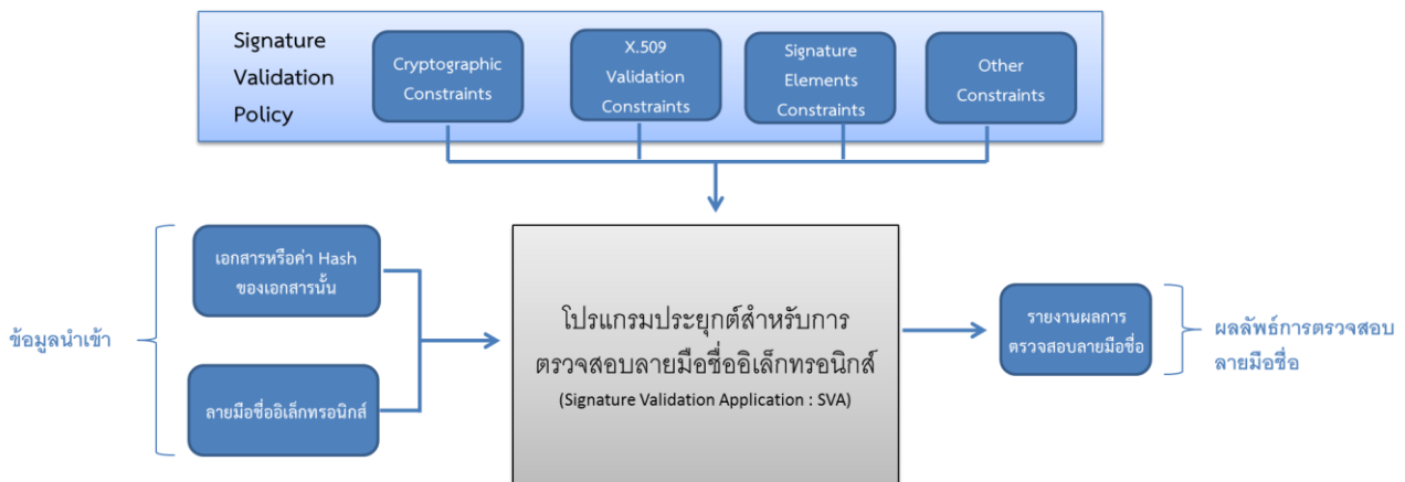
รูปที่ 12 แบบจำลองการตรวจสอบลายมือชื่ออิเล็กทรอนิกส์
