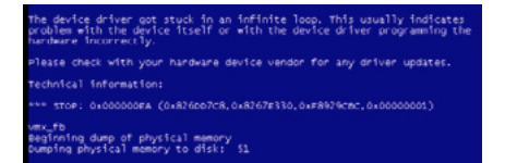
รูปที่ 15. รูปที่ 18 (16-1) BSOD ที่เกิดจากช่องโหว่ ATMF.DLL [16-2]
